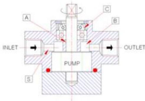
必须按照箭头方向旋转,如泵逆转容易破坏密封件。现齿轮泵虽然是如左侧图所示出油,是受到压力油通过轴进入(A)里面OIL SEAL部位通过(C) DRAIN HOLE回到(B)吸入口的(S)形式设计,如果泵逆转,移送方向就会相反,油通过DRAIN HOLE到OIL SEAL内部,并会破坏OIL SEAL,油逆流。
