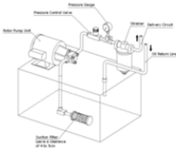
油箱里的正确容量为每分钟流量的3-4倍，如考虑空间选择小一点的油箱供油不及时会出现吸油不稳定，即使油的回流速度快也会使油面不稳定，油温上升，而且会造成油污染，吸入口的油温要保持55℃以下。
