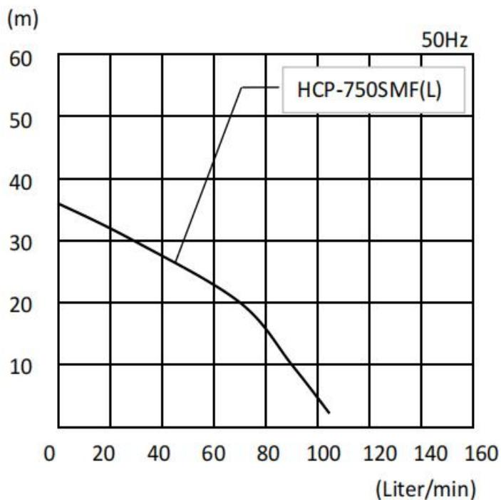
\*使用非水溶性切削液时，应使用32cSt以下粘度；相比使用水溶性切削液，泵性能(压力、流量)降低。
